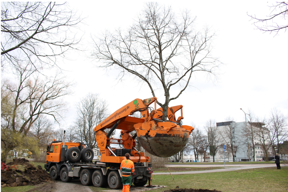
Figur 1. Flytt av träd med specialmaskin.
