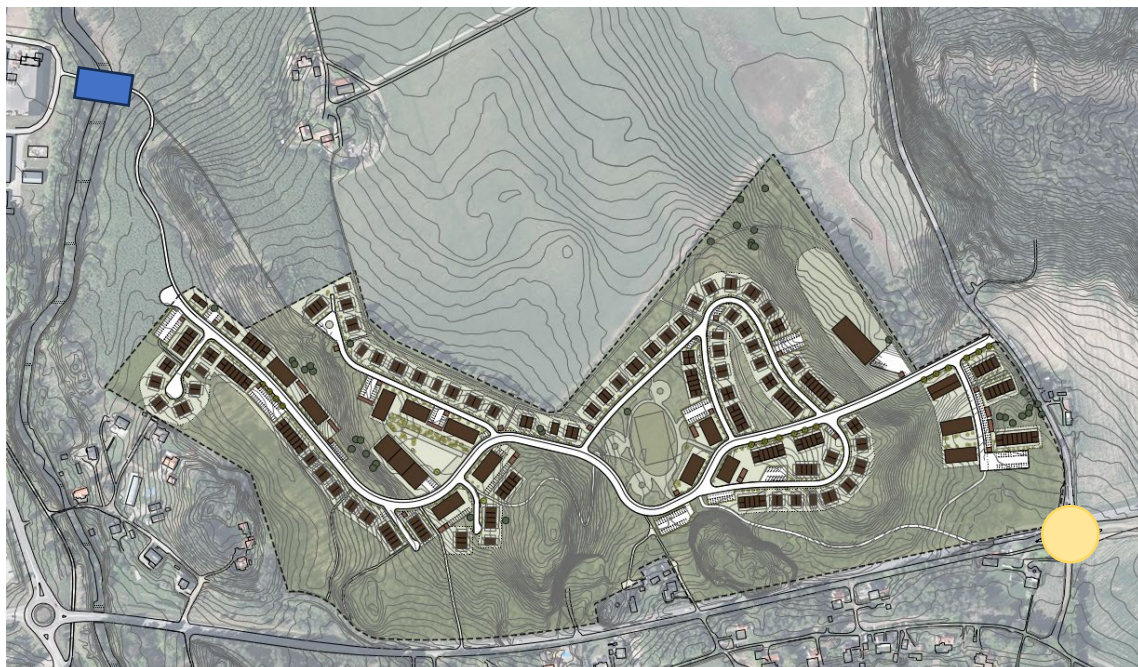
Figur 1. Vägnätet i Visbohammar. Den nya cirkulationsplatsen är markerad med gul cirkel och den nya bron är markerad med blå rektangel. (Källa: Signum Fastigheter, egen bearbetning)
