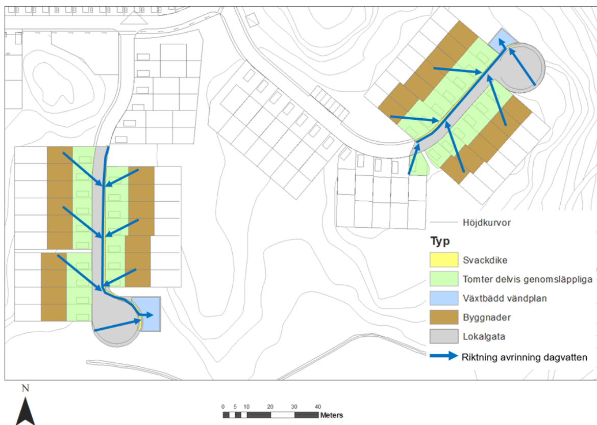
Figur 14. Principskiss över vilka områden som har sin avrinning till föreslagna nedsänkta växtbäddar i anslutning till vändplanerna.
