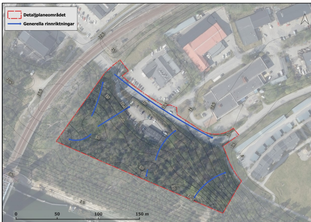
Figur 5-1. Detaljplaneområdet med befintlig markanvändning (ortofoto), höjdkurvor och generella rinnriktningar. Höjddata baserade på befintlig situation.
