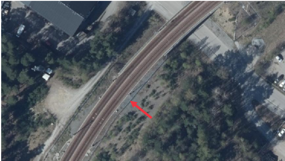
Figur 3. Placering mätposition 5,5 m från närmaste spår.
