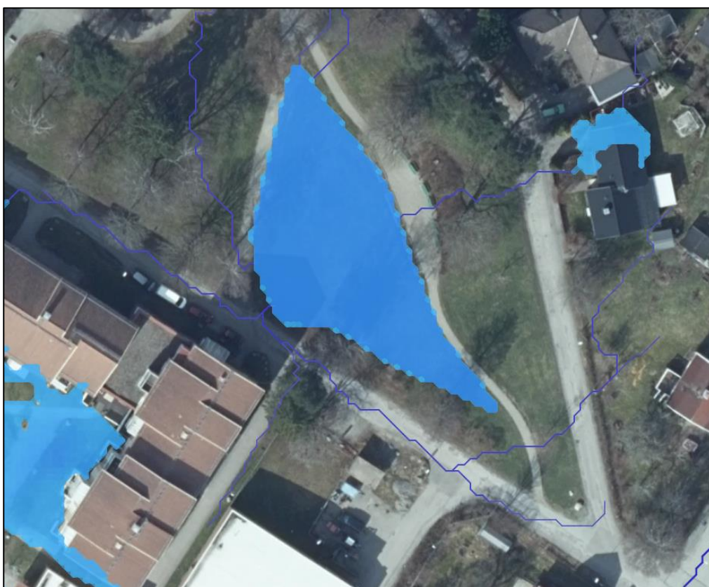
Figur 8. Nedsänkt skyfallsyta i Centralparken, närbild
