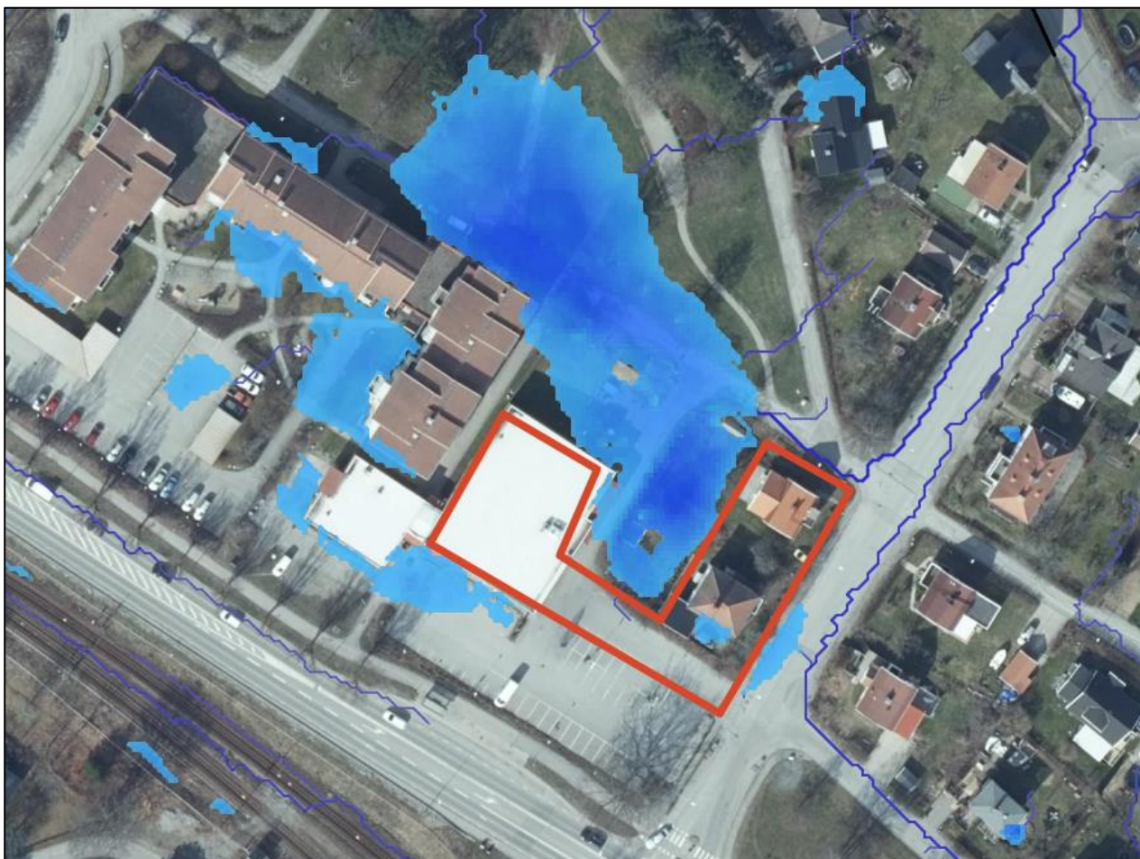
Figur 5. Exploateringens fotavtryck inom planområdet för att undvika risk för skador vid översvämning vid ett 100-årsregn
