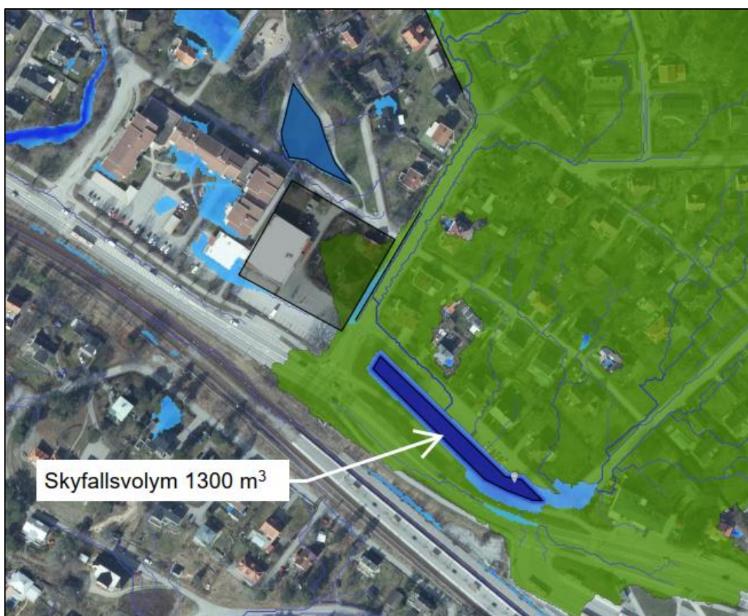
Figur 10. Nedsänkt skyfallsyta längs Grödingevägen
