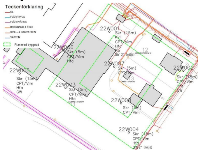
Figur 5.2. Ledningar inom undersökningsområdet i förhållande till planerade undersökningspunkter (Borrplan 2022-04-05).
