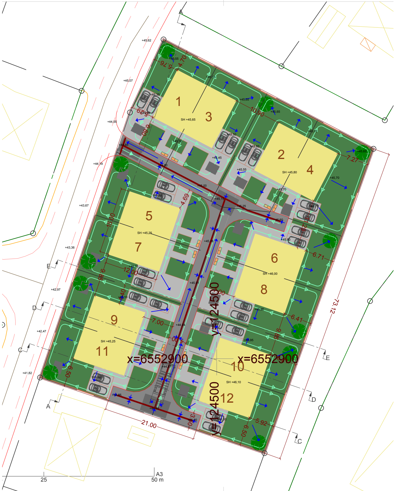
Förslag på dagvattenlösning med magasin i grått, flödespilar i blått och ledningar i ljusgrönt.
