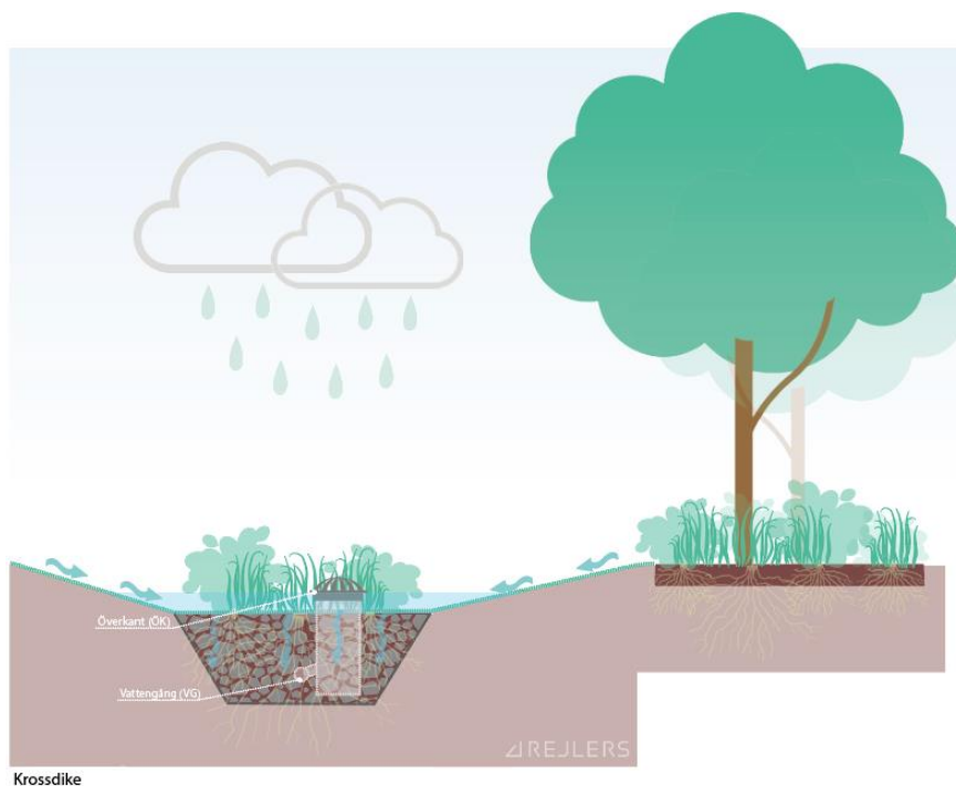
Figur 7-15. Principskiss av krossdike längs med gator (Rejlers Sverige AB, 2024).
