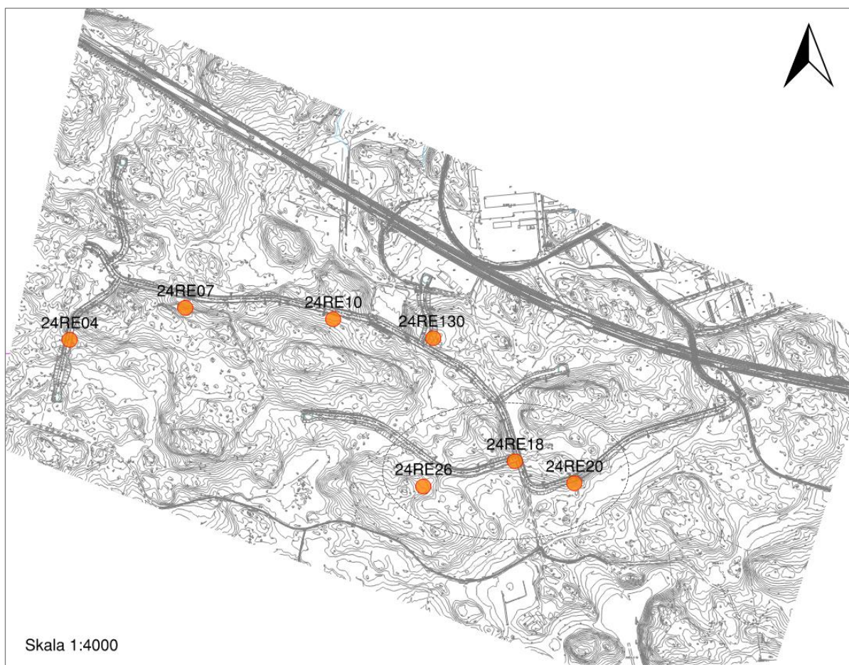
Figur 3-7. Provtagningspunkter för sulfidutredning (Rejlers Sverige AB, 2024c). Provtagningspunkter med förhöjd svavelhalt har markerats med en röd cirkel.
