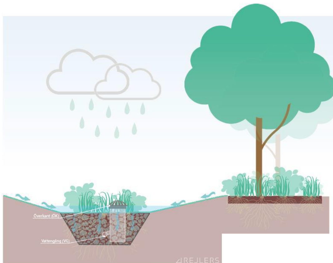
Figur 18. Principskiss av krossdike längs med gator. Källa: Dagvattenutredning, Rejlers (2024)
