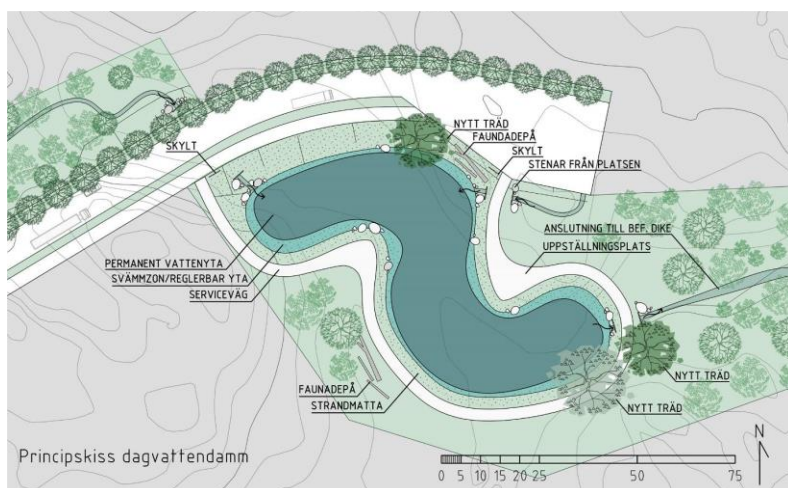
Figur 24. Principskiss med plantering och kompletterande anläggningar vid damm. Källa: PM Landskap, Rejlers (2024)
