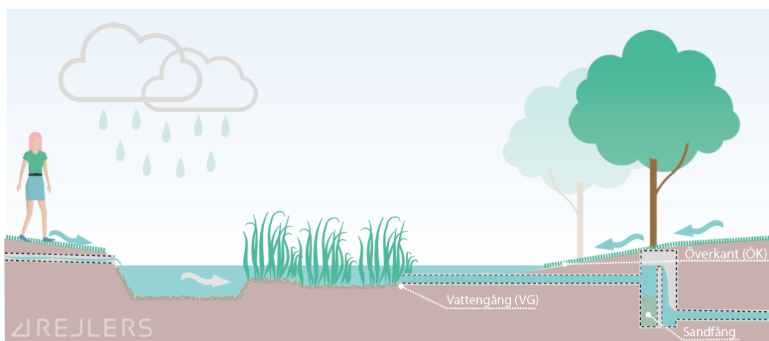
Figur 17. Principskiss för en dagvattendamm med en grund våtmarksdel. Källa: Dagvattenutredning, Rejlers (2024)
