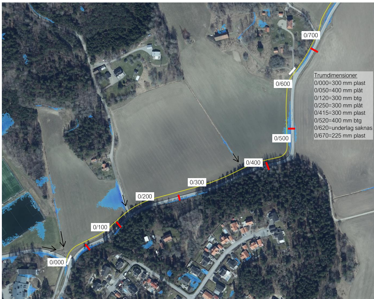
Figur 10. Sektion 0/000–0/700 där Trafikverkets trummor (röda streck) och privata trummor (vita streck) visas tillsammans med lågpunkter (blåa fält) samt trumdimensioner och svarta pilar för diken som rinner mot Sandviksvägen, SCALGO
