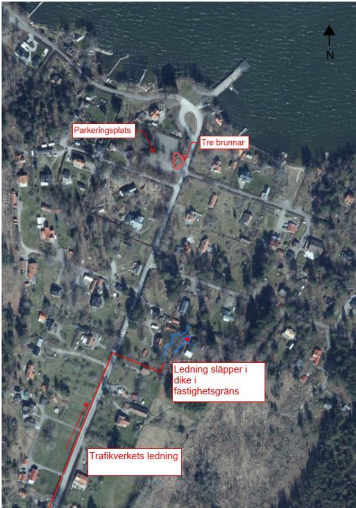
Figur 13. Trafikverkets ledning som antas mynna ut i dike i fastighetsgräns.
