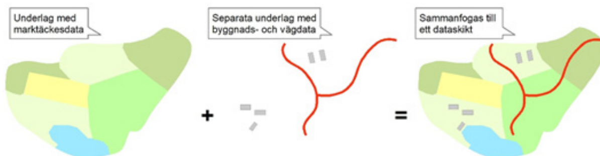
Figur 10. Olika underlag används för att skapa ett motståndslager.
