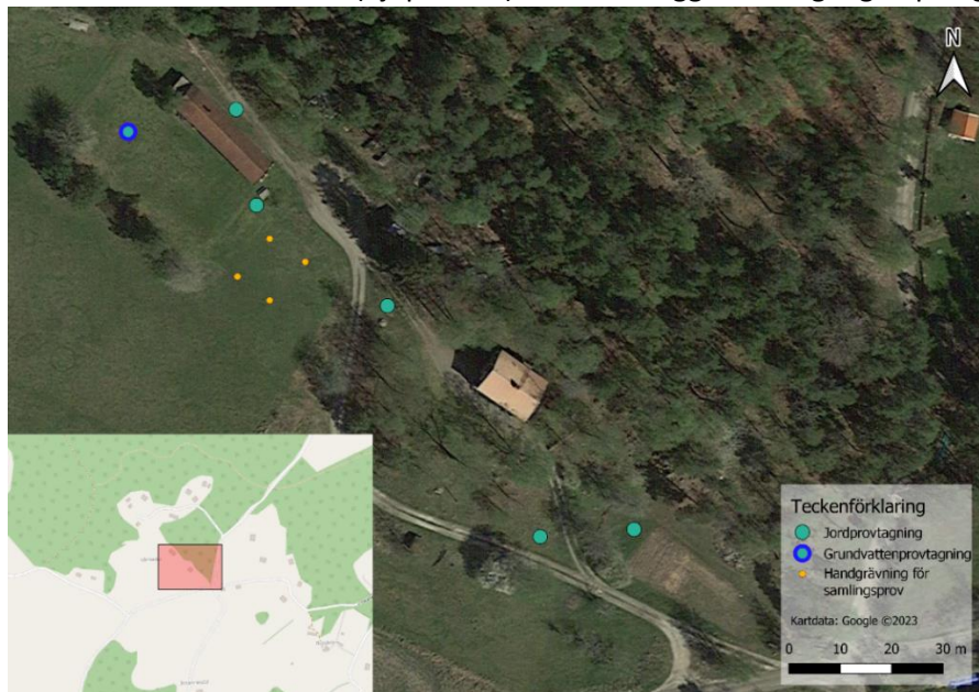
Figur 11a. Karta över provpunkternas placering, borrhpunkter i grönt och handgrävning i gult.
