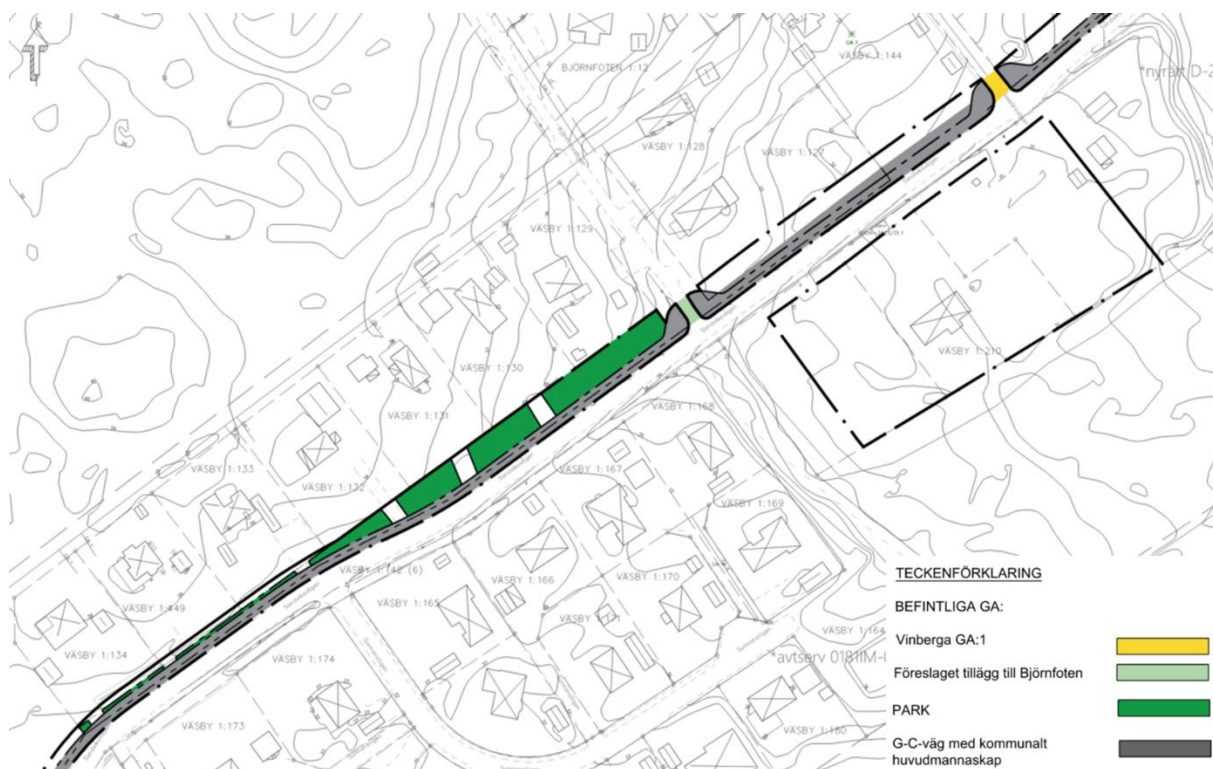
Figur 139 Där Björnfotsvägen ansluter mot Sandviksvägen korsar den planerade GC-vägen inom planområdet. Infartsvägen ligger utanför vägföreningens förvaltning och saknar tydlig huvudman. Infarten föreslås inrättas i föreningens förvaltning genom nytt anläggningsbeslut.
