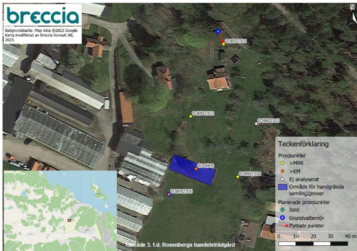
Figur 83 Område 3 F.d. Rosenbergs Handelsträdgård. Provtagningsplan som redovisar provtagningspunkter och strukna punkter. Källa: MTMU, Breccia, 2023
