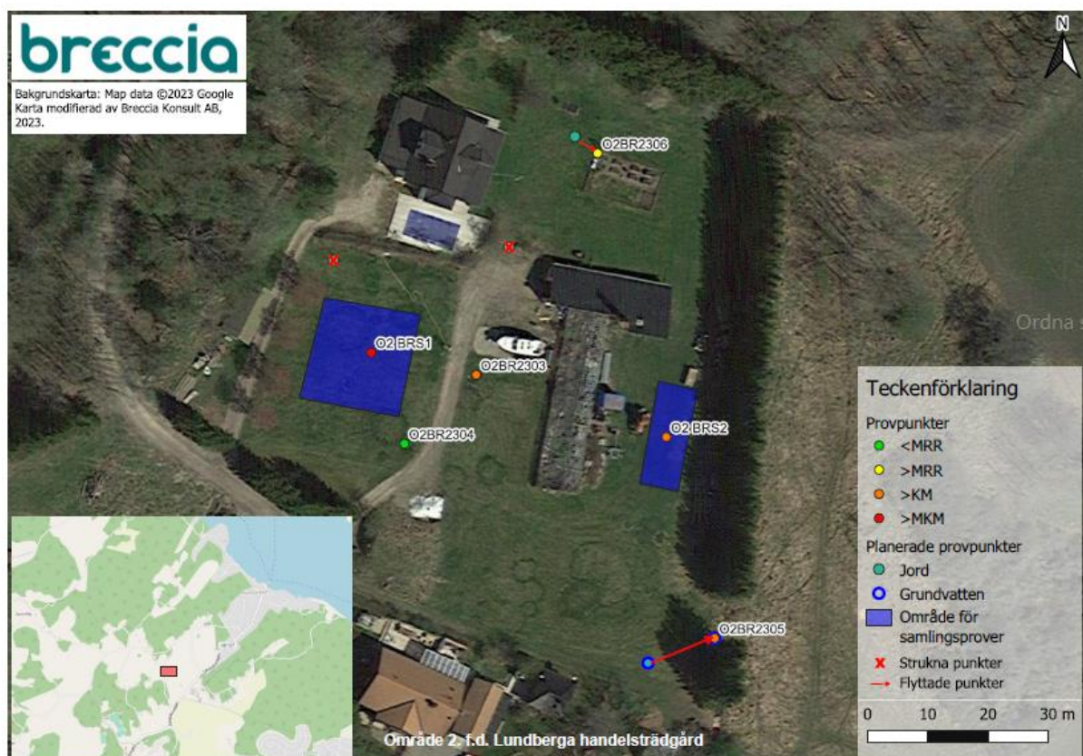
Figur 82 Område 2 F.d. Lundberga Handelsträdgård. Provtagningsplan som redovisar provtagningspunkter och strukna punkter. Källa: MTMU, Breccia, 2023
