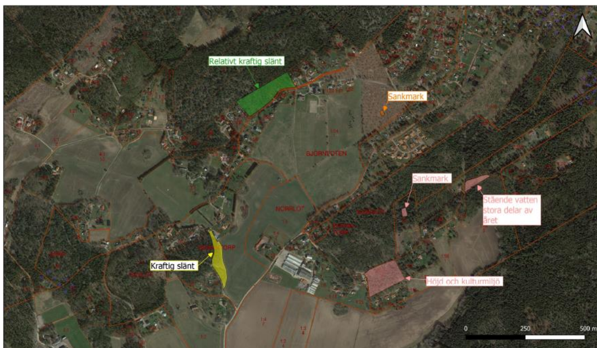
Figur 94 Tekniskt komplicerade områden i och omkring planområdet. Källa: Översiktlig geoteknisk utredning, 2022.
