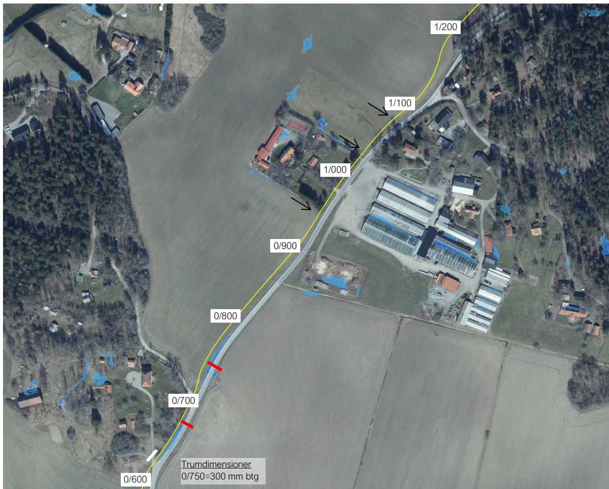
Figur 11. Sektion 0/700–1/150 där Trafikverkets trumma (rött streck) visas tillsammans med lågpunkter (blåa fält) samt trumdimensioner och svarta pilar för diken som rinner mot Sandviksvägen, SCALGO
