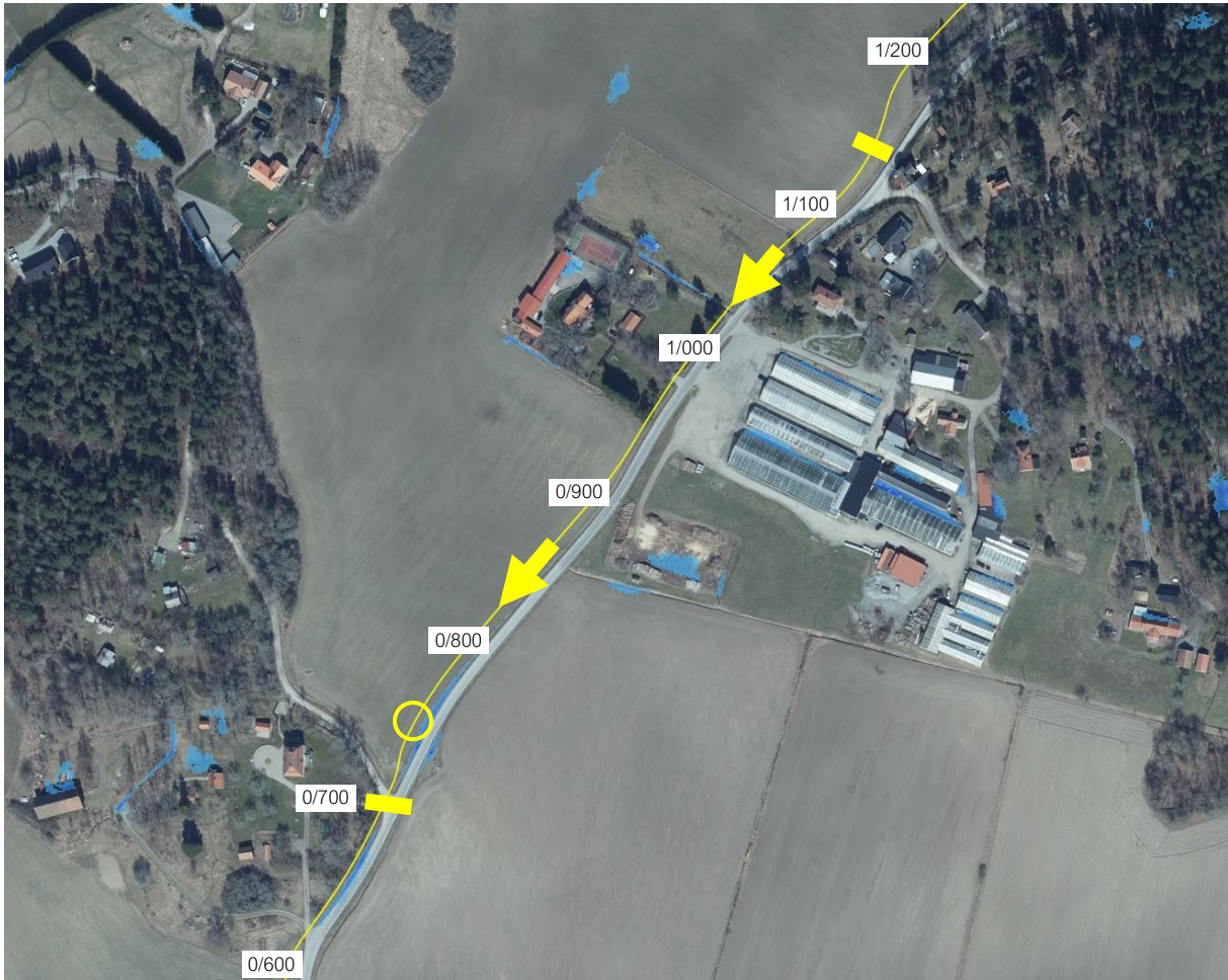
Figur 34. Sektion 0/700–1/150 anger delavrinningsområde mellan gula avgränsningslinjer (högpunkter) och generell flödesriktning markerad med gula pilar. Dagvatten från GC-vägen avleds till gräsdike och makadamdike där allt dagvatten infiltrerar vid regn med återkomsttiden 12 månader enligt Tabell 8, SCALGO
