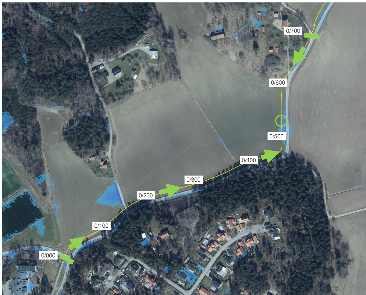
Figur 33. Sektion 0/000–0/700 anger delavrinningsområde mellan gröna avgränsningslinjer (högpunkter) och generell flödesriktning markerad med gröna pilar. Dagvatten från GC-vägen avleds till gräsdike och makadamdike där allt dagvatten infiltrerar vid regn med återkomsttiden 12 månader enligt Tabell 8, SCALGO
