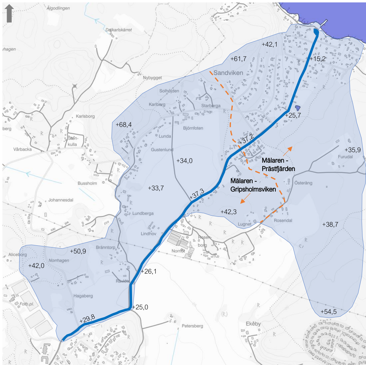
Figur 3. Översiktsbild med befintliga marknivåer och vattendelare, SCALGO
