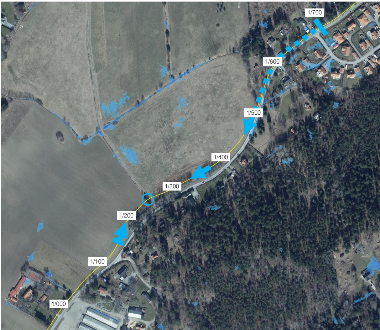
Figur 35. Sektion 1/150–1/700 anger delavrinningsområde mellan blåa avgränsningslinjer (högpunkter) och generell flödesriktning markerad med blåa pilar. Streckad blå linje visar kantstöd, gallerbrunnar och dagvattenledning med utlopp i sektion 1/485. Dagvatten från GC-vägen avleds till gräsdike (1/150–1/485) och gallerbrunnar (1/485–1/700) där allt dagvatten infiltrerar vid regn med återkomsttiden 12 månader enligt tabell 8, SCALGO
