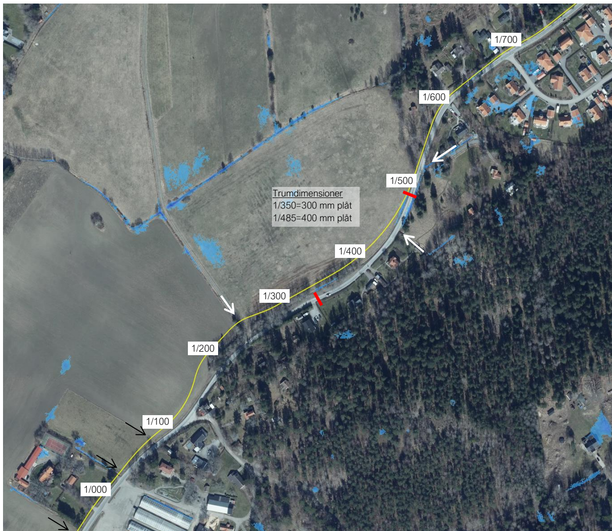
Figur 12. Sektion 1/150–1/700 där Trafikverkets trummor (röda streck) visas tillsammans med lågpunkter (blåa fält) samt trumdimensioner och vita pilar för diken som rinner mot Sandviksvägen, SCALGO
